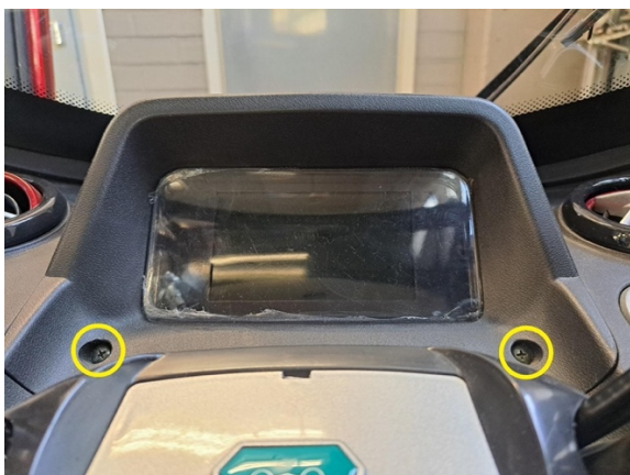
Irrota mittariston kiinnitysruuvit. (ristipäämeisseli ph2).
